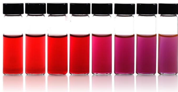
Σχήμα 2.2 Κολλοειδή διαλύματα σφαιρικών νανοσωματιδίων χρυσού διαφορετικών μεγεθών (ξεκινώντας από αριστερά: 20, 30, 40, 50, 60, 70, 80, 100 nm).
