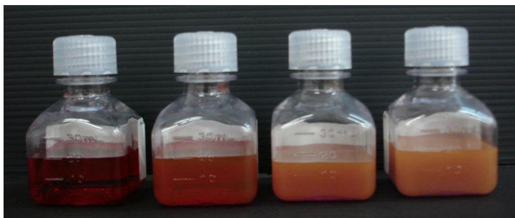
Σχήμα 5.3 Φωτογραφία κολλοειδών διαλυμάτων χρυσού διαφορετικών μεγεθών, από αριστερά προς τα δεξιά: 40, 60, 80, 100 nm.
