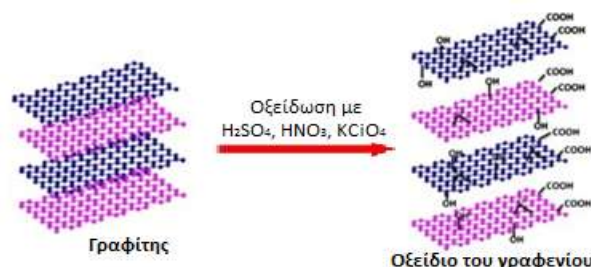
Σχήμα 3.1 Σχηματική αναπαράσταση παρασκευής GO
