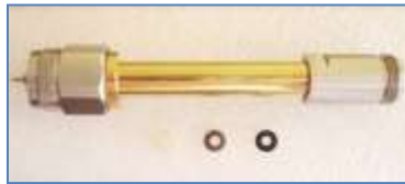
Σχήμα 3.18 Ομοαξονική θήκη χαρακτηρισμού με μικροκύματα και τρεις δακτύλιοι των σύνθετων δοκιμίων
