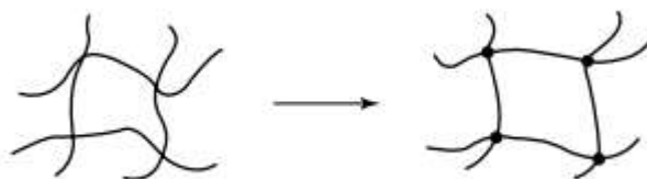
Σχήμα 1.3 Διασταύρωση πολυμερών – σταυροδεσμοί [4]
