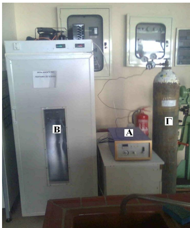
Εικόνα 1. Πειραματική διάταξη οζονισμού (πηγή: προσωπικό αρχείο) A: Οζονιστήρας, B: Ψυγείο, Γ: Φιάλη οξυγόνου
