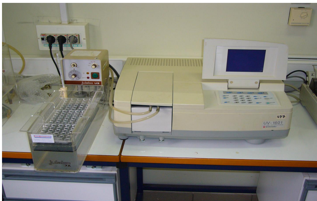
Εικόνα 8. Η μετρητική διάταξη των πειραμάτων (φωτόμετρο Shimadzu συνδεδεμένο με υδατόλουτρο Julabo με ρυθμιζόμενο θερμοστάτη).
