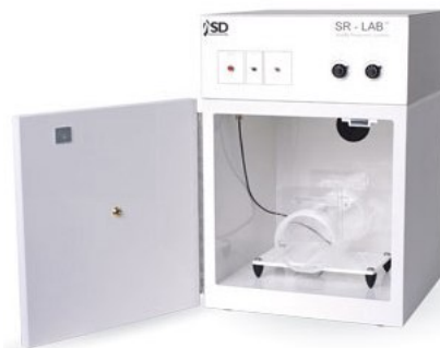
Εικόνα 2.7. Η πειραματική διάταξη ηχομονωμένου θαλάμου εκτέλεσης της δοκιμασίας Προ-Παλμικής Αναστολής του Αντανακλαστικού του Αιφνιδιασμού.
