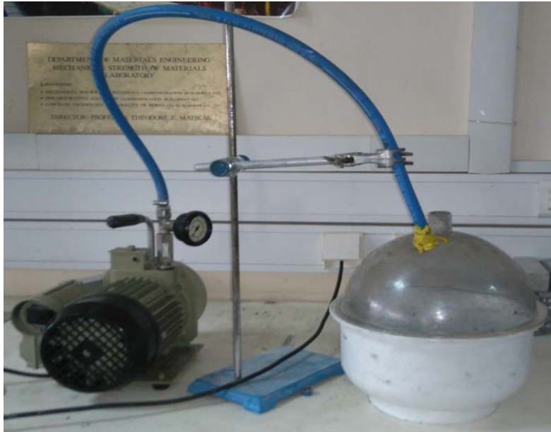
Εικόνα 8.6 Διαδικασία απαέρωσης των αιωρημάτων
