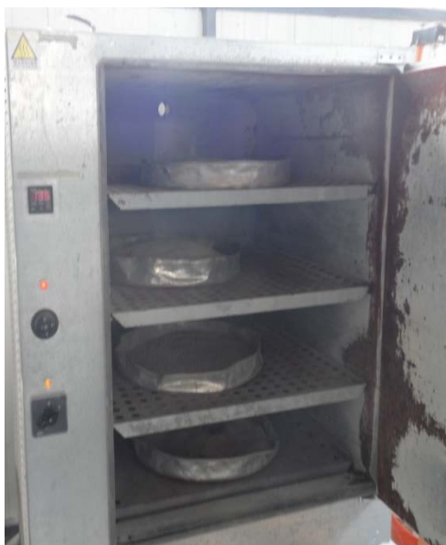
Εικόνα 8.1 Εργαστηριακός φούρνος ξήρανσης με τα αδρανή στο εσωτερικό του
