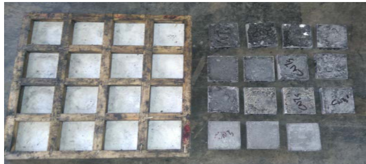
Εικόνα 8.11 Η εξαγωγή και η σημείωση των νάνο-ενισχυμένων δοκιμίων κονιαμάτων με νανοσωλήνες άνθρακα
