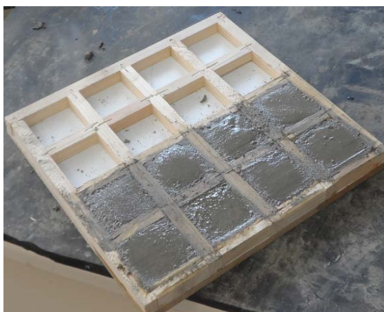
Εικόνα 8.8 Η μήτρα μετά την έκχυση του κονιάματος για τα δοκίμια αναφοράς
