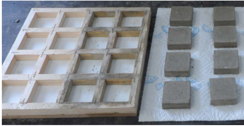
Εικόνα 8.10 Τα οκτώ δοκίμια αναφοράς μετά την εξαγωγή τους από τη μήτρα
