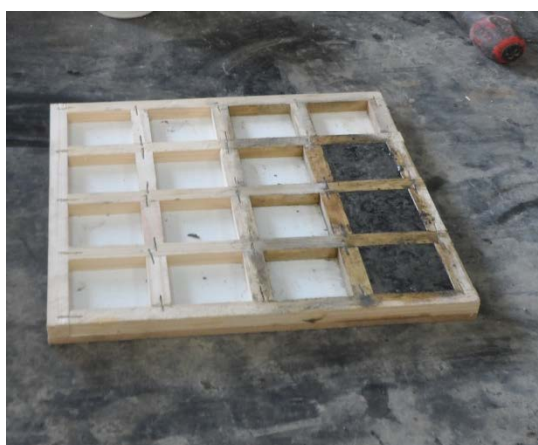
Εικόνα 8.9 Η μήτρα μετά τη σταδιακή έκχυση του νανο-ενισχυμένου κονιάματος συγκεκριμένου ποσοστού νανοσωλήνων άνθρακα κατά βάρος τσιμέντου. Στις εικόνες 8.7,8.8,8.9 παρατηρούμε την διαδικασία πλήρωσης των καλουπιών.
