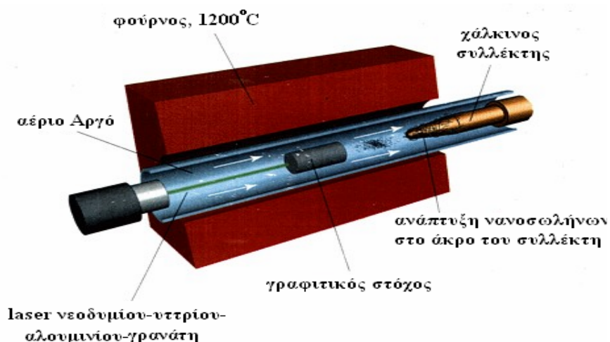
Σχήμα 4.5 Μέθοδος εξάχνωσης γραφίτη μέσω παλμικού laser [21]
