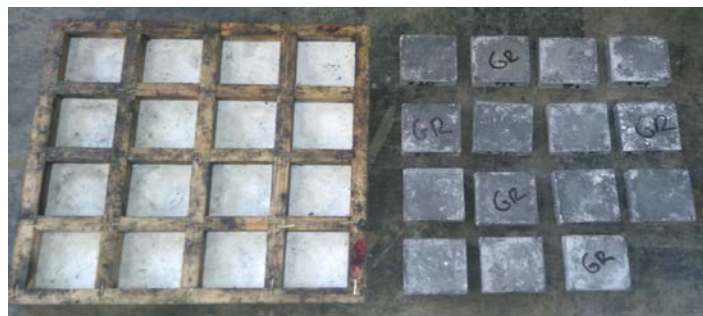
Εικόνα 8.12 Η εξαγωγή και η σημείωση των νάνο-ενισχυμένων δοκιμίων κονιαμάτων με γραφένιο
