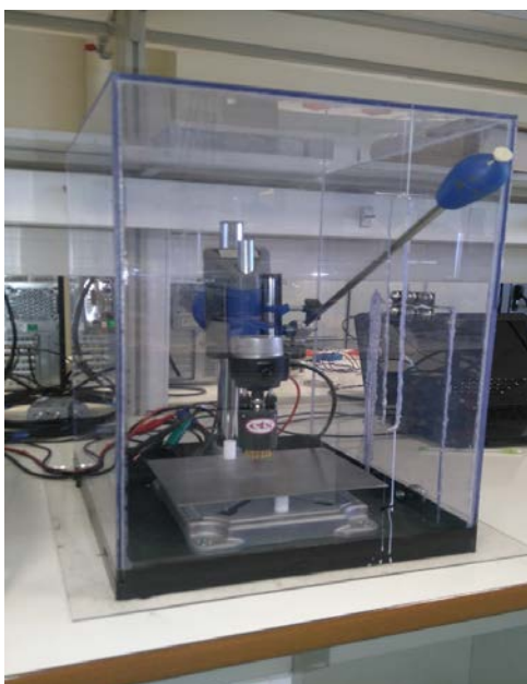
Εικόνα 8.17 Η ιδιοσυσκευή χωρίς τη μονωτική βάση για τη μέτρηση της ηλεκτρικής αντίστασης σε όλο τον όγκο του δοκιμίου
