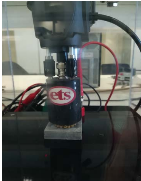
Εικόνα 8.16 Η επιφάνεια του εξεταζόμενου δοκιμίου εφαπτόμενη με τον δακτύλιο των ηλεκτροδίων της ιδιοσυσκευής
