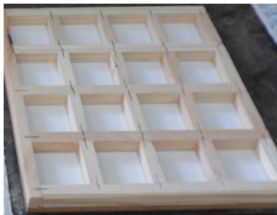
Εικόνα 8.7 Μήτρα-καλούπι 16 δοκιμίων διαστάσεων 40*40*10mm
