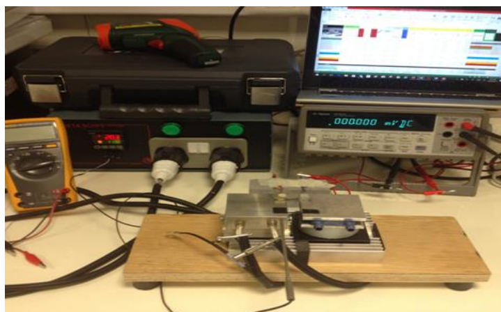
Εικόνα 2. Διάταξη θερμοηλεκτρικών μετρήσεων και εξοπλισμός που χρησιμοποιήθηκε.
