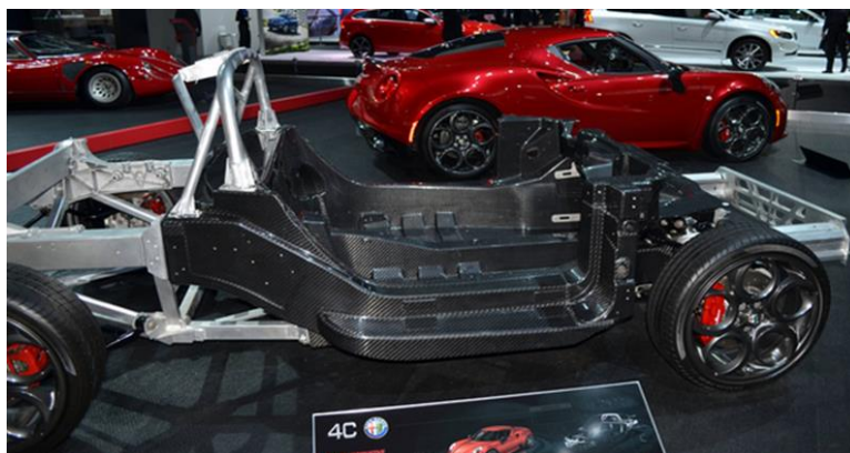
Alfa Romeo 4C, σασί από CFRP στα 65 kg. 3
