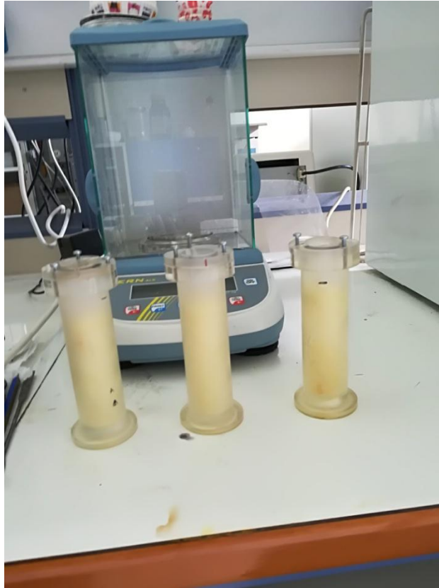
Εικόνα 3.7 : Δοχεία από Plexiglas, με προσροφητικό υλικό ξηρής silica-gel του εργαστηρίου Τεχνολογίας Τροφίμων του Τμήματος Διοίκησης Επιχειρήσεων Αγροτικών Προϊόντων και Τροφίμων, του Πανεπιστημίου Πατρών.
