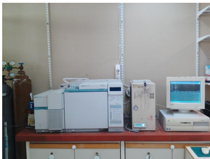
Εικόνα 12. Αέριος χρωματογράφος Hewlett-Packard 6890 με ανιχνευτή φασματογράφο μάζας.
