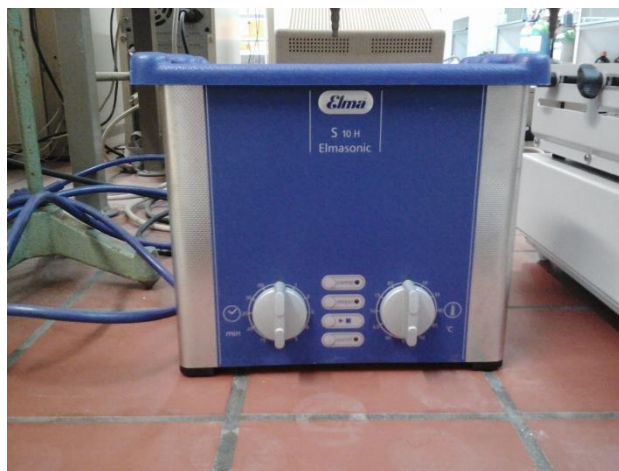
Εικόνα 11. Υδατόλουτρο υπερήχων Elmasonic S10 H
