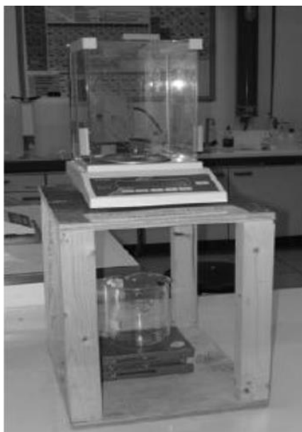
Εικόνα 4.2. Πειραματική διάταξη για μετρήσεις πυκνότητας.
