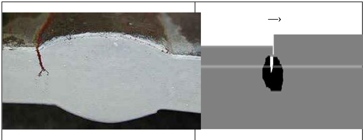
Εικόνα 1.19: Διάβρωση με μηχανική καταπόνηση
