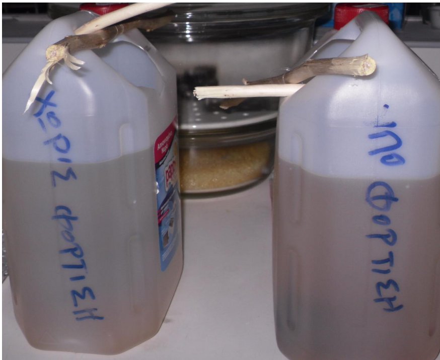
Εικόνα 3.1 : Δοκίμια σε 3,5% κ.β. NaCl 15 ημερών (υπό και χωρίς φόρτιση)
