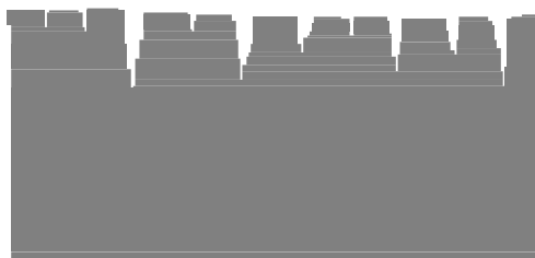
Εικόνα 1.10: Διάβρωση με βελονισμούς
