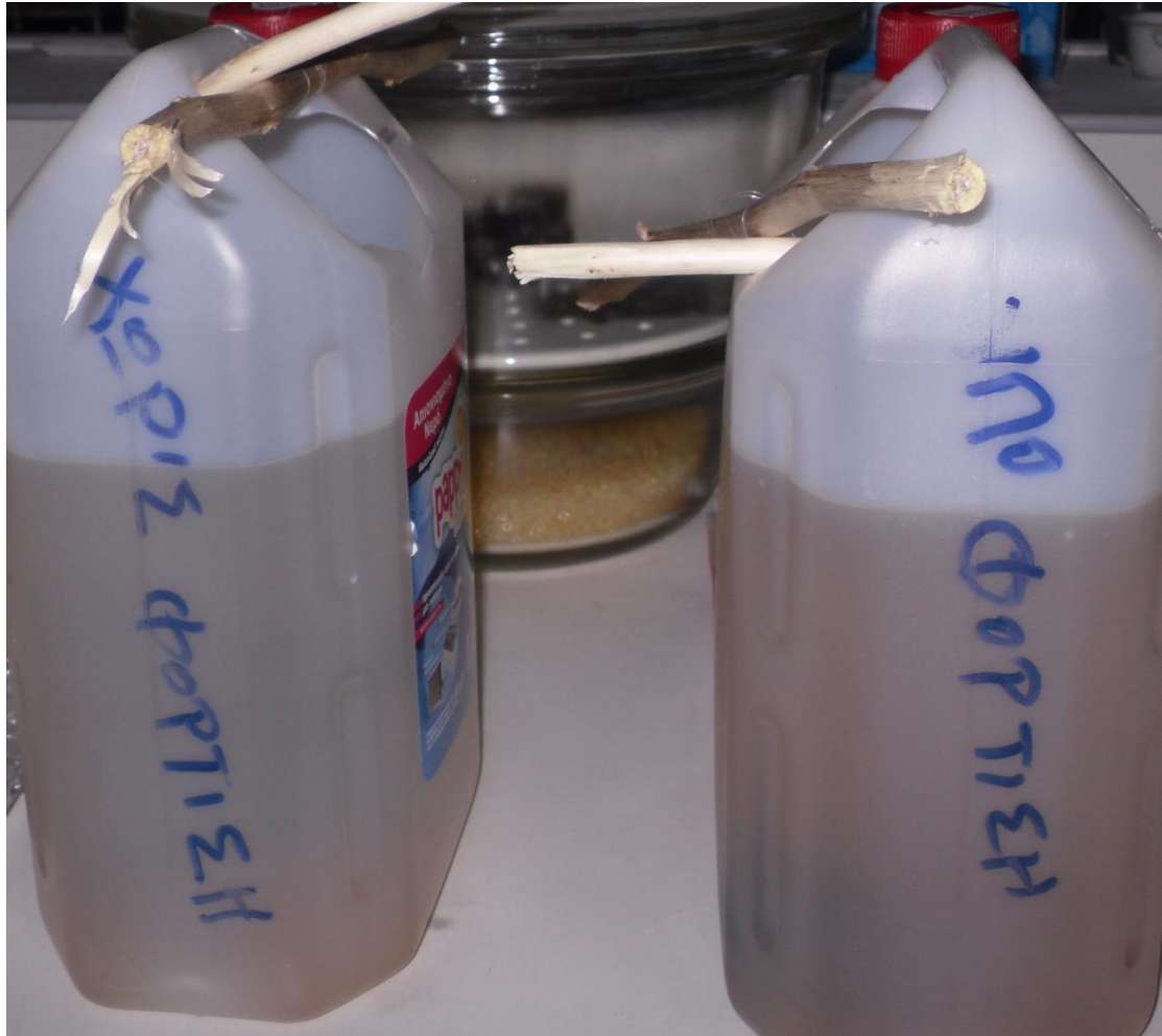
Εικόνα 2.8: Δοκίμια σε 3,5% κ.β. NaCl 15 ημερών (υπό και χωρίς φόρτιση)
