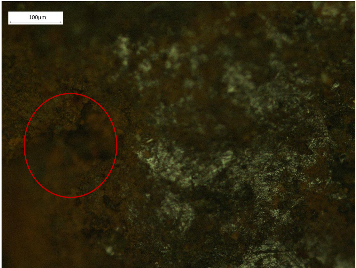
Εικόνα 3.14: Σύνδεσμος βάσης ΥΕ σε Οξείδωση
