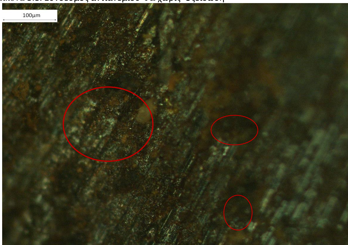
Εικόνα 3.9: Σύνδεσμος αντιανεμίου στην άκρη ΥΕ σε Οξείδωση
