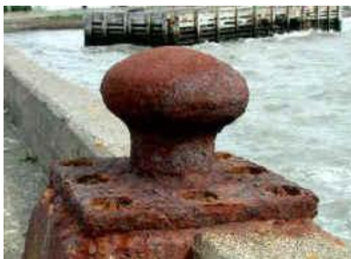
Εικόνα 1.7: Ομοιόμορφη ή γενική διάβρωση
