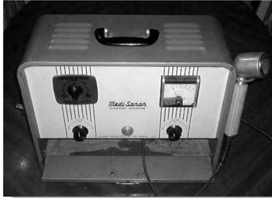
Γεννήτρια υπερήχων, “Medi-Sonar,1950
