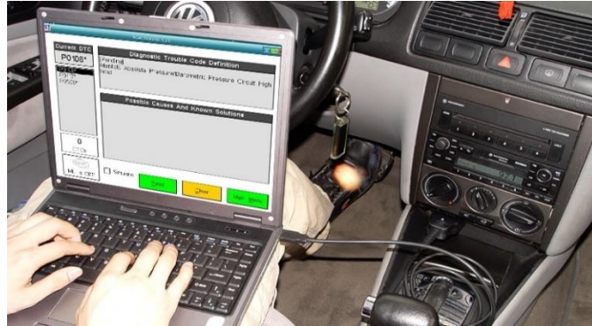
Σχήμα 2.5 Φορητό Εργαλείο Διάγνωσης Εγκατεστημένο σε Φορητό Υπολογιστή
