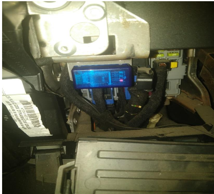
Σχήμα 4.2 ELM327 Εγκατεστημένος σε Όχημα Δοκιμής
