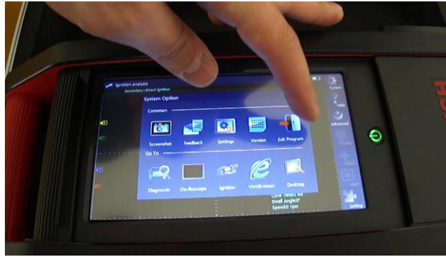
Σχήμα 2.4 Φορητό Εργαλείο Διάγνωσης Εγκατεστημένο σε Tablet
