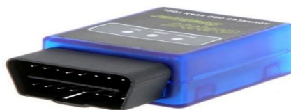
Σχήμα 2.6 Καταγραφέας Δεδομένων Χωρίς Δυνατότητα Αποθήκευσης
