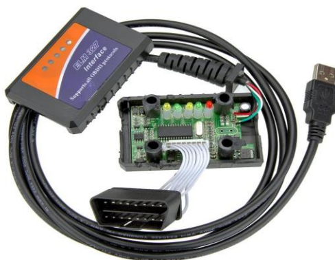
Σχήμα 3.3 Κλώνος του ELM327 Χωρίς Έκδοση του Πρωτοκόλλου
