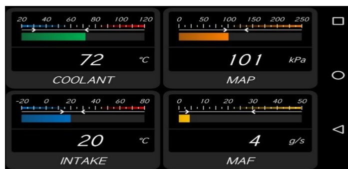
Σχήμα 4.7 Εμφάνιση Δεδομένων Εύρυθμης Λειτουργίας του Κινητήρα
