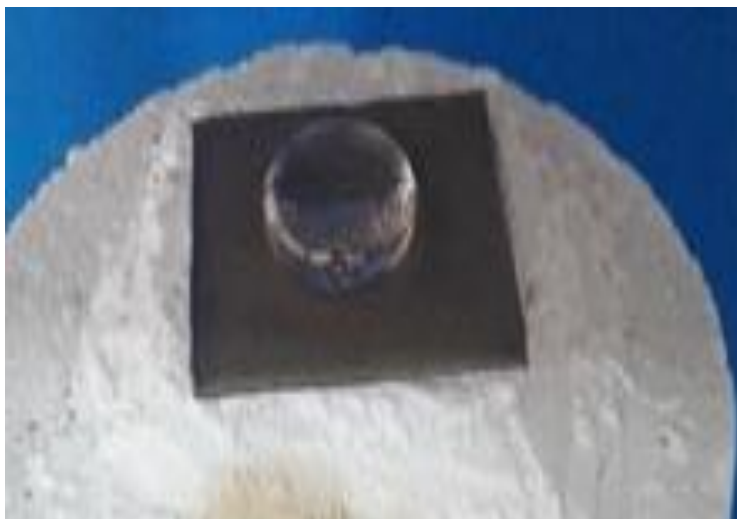
Εικόνα 20. Η ύαλος μετά τη διαδικασία ανόπτησης.
