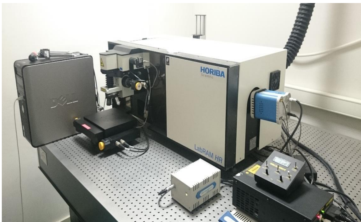
Εικόνα 22. Διάταξη φασματογράφου Raman.
