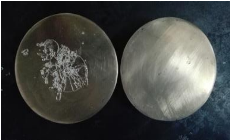
Εικόνα 15. Υαλόθραυμα της βιοενεργής υάλου 45S5 μετά τη διαδικασία splat-cooling ανάμεσα σε δύο μεταλλικές πλάκες.
