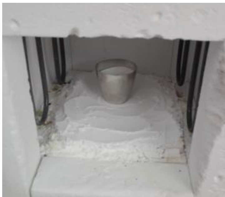
Εικόνα 14. Τοποθέτηση του χωνευτηρίου πλατίνας στο φούρνο για την τήξη του δείγματος.
