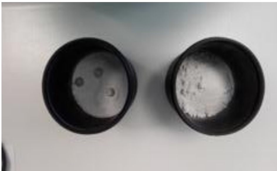
Εικόνα 11. Σκόνη μετά τη διαδικασία άλεσης για την ομογενοποίησή της.
