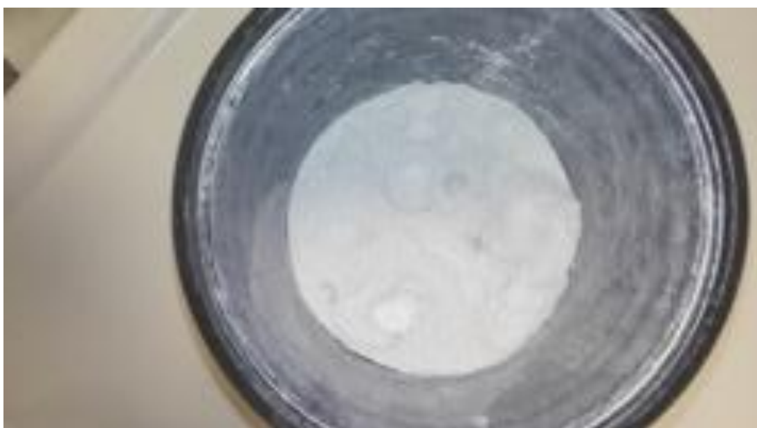
Εικόνα 12. Σκόνη μετά τη διαδικασία άλεσης για την ομογενοποίησή της.
