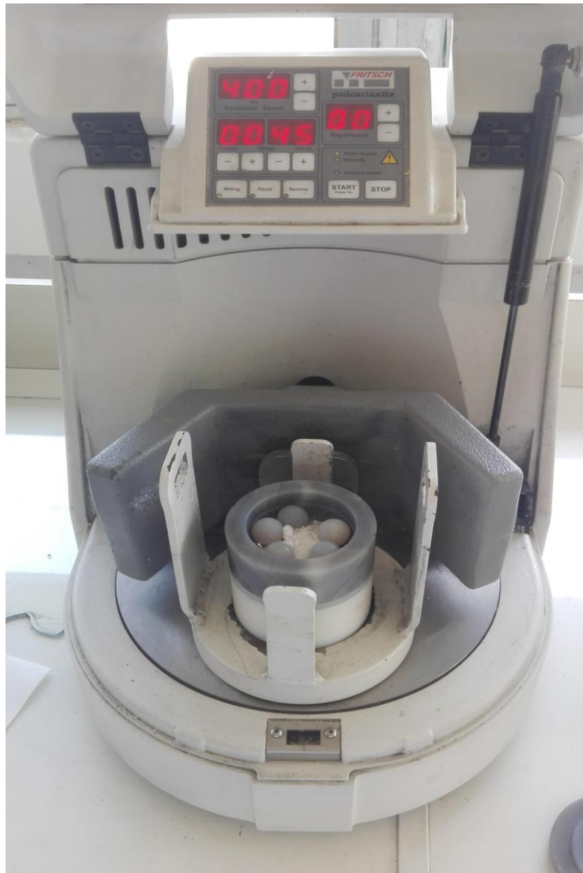
Εικόνα 10. Πλανητικός μύλος ο οποίος χρησιμοποιήθηκε για τη διαδικασία άλεσης.
