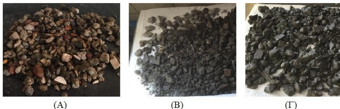
Εικόνα 4.22 Ανακυκλωμένα αδρανή κατόπιν (Α) εμφύσησης σε υδρόφοβο προϊόν, (Β) επικάλυψης με τσιμεντόπαστα λόγω νερού προς τσιμέντο ίση με 1 και (Γ) επικάλυψης με τσιμεντόπαστα λόγω νερού προς τσιμέντο ίση με 0,5.
