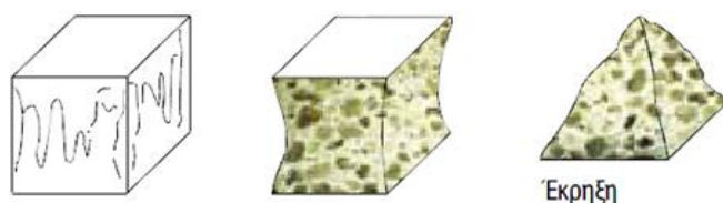
Εικόνα 3.18 Συνήθης μορφές αστοχίας θλιπτικής αντοχής [145].
