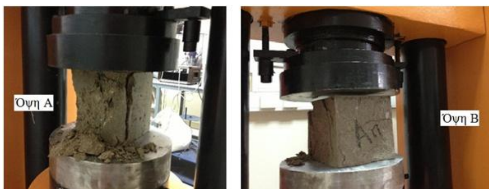
Εικόνα 4.7 Δοκίμιο μετά τη δοκιμή θλιπτικής αντοχής (δύο όψεις).
