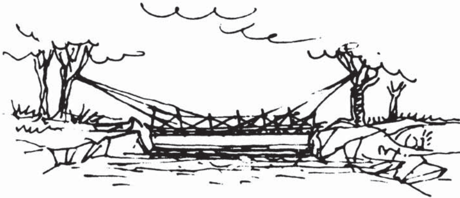
Εικ. 6. Κρεμαστή παραδοσιακή γέφυρα.
