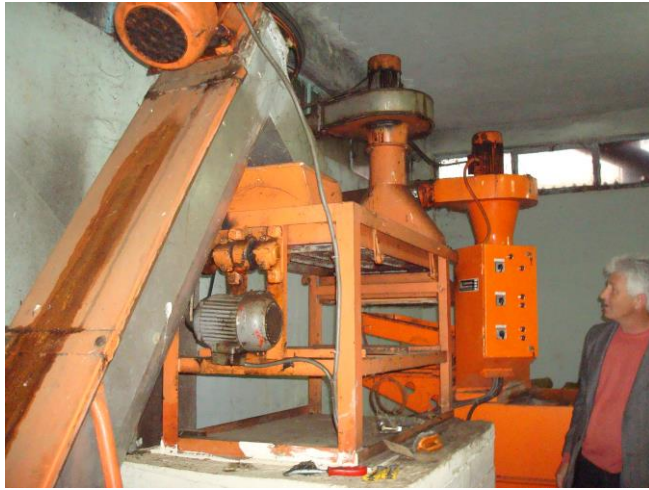
Μηχανοκίνητο ελαιοτριβείο Λιθερού-Μαλακτήρας
