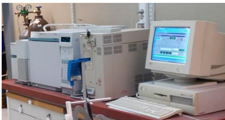
Σχήμα 35: Συσκευή αέριας χρωματογραφίας-φασματομετρίας μάζας
