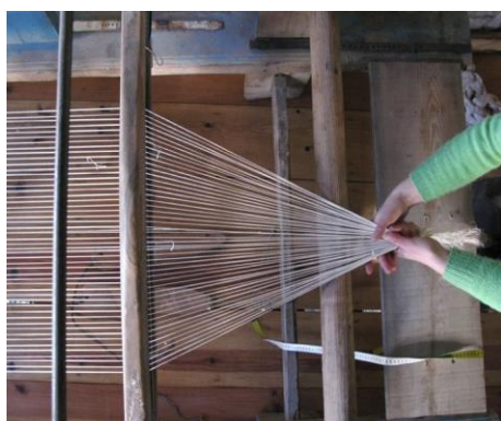
Εικόνα 19: Ενσωμάτωση του διασιδιού στον αργαλειό, φωτογραφίες από το διαδικίκο
