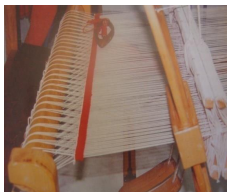
Εικόνα 19: Ενσωμάτωση του διασιδιού στον αργαλειό, φωτογραφίες από το διαδικίκο
