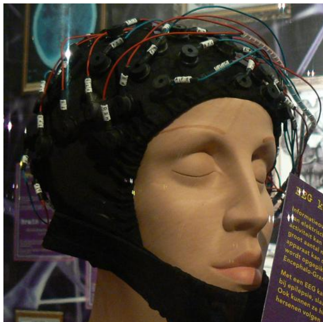
Εικόνα 29: Ελαστικό καπέλο με τα 32 ηλεκτρόδια (public domain image, free to use, share or modify, even commercially)
