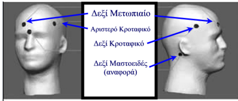
Εικόνα 30: Τοπολογία ηλεκτροδίων με το μαστοειδές ως αναφορά (public domain image, free to use, share or modify, even commercially)
