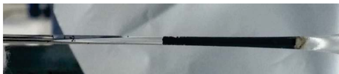
Εικόνα 6.3. Νάνο-βιοαντιδραστήρας CLEAs τυροσινάσης (40 mm μήκος, 0.9 mm διάμετρος)
