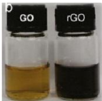
Εικόνα 21: Αναγωγή του GO μέσω υδραζίνης και παραγωγή RGO. Είναι φανερή η αλλαγή χρώματος του διαλύματος μετά την αναγωγή.
