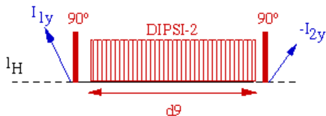
Σχήμα 4.2: Παλμική ακολουθία του πειράματος επιλεκτικό TOCSY μιας διάστασης (Selective 1D TOCSY).
