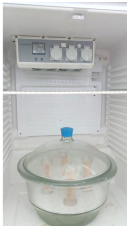
Εικόνα 3.11: Μέτρηση διαπερατότητας υγρασίας των φιλμ στο Εργαστήριο Τεχνολογίας Τροφίμων του Τμήματος Διοίκησης Επιχειρήσεων Αγροτικών Προϊόντων και Τροφίμων, του Πανεπιστημίου Πατρών.
