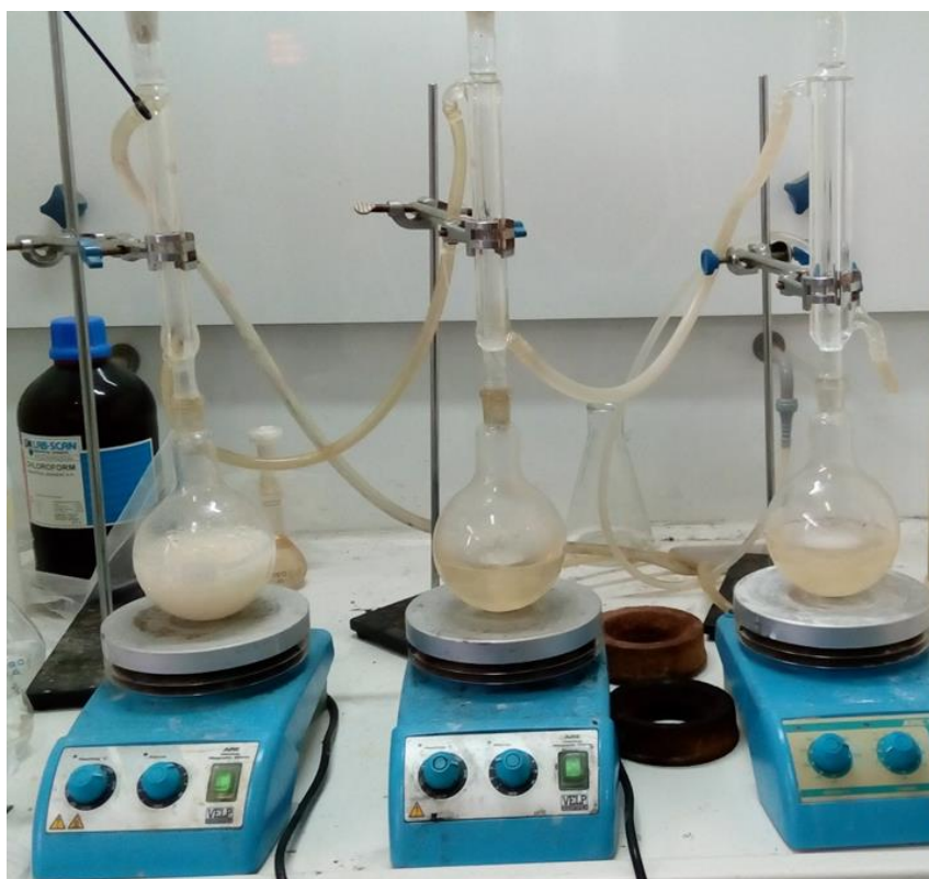
Εικόνα 3.1: Παρασκευή χιτοζάνης, χιτοζάνης-γλυκερόλης και χιτοζάνης-πολυβινυλαλκοόλης στο Εργαστήριο Τεχνολογίας Τροφίμων του Τμήματος Διοίκησης Επιχειρήσεων Αγροτικών Προϊόντων και Τροφίμων, του Πανεπιστημίου Πατρών.
