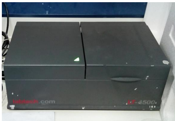
Εικόνα 3.16: Φωτομέτρηση δειγμάτων στο φωτόμετρο ELISA, LT-4500 του Εργαστηρίου Βιοτεχνολογίας, του Τμήματος Βιολογικών Εφαρμογών και Τεχνολογιών, του Πανεπιστημίου Ιωαννίνων
