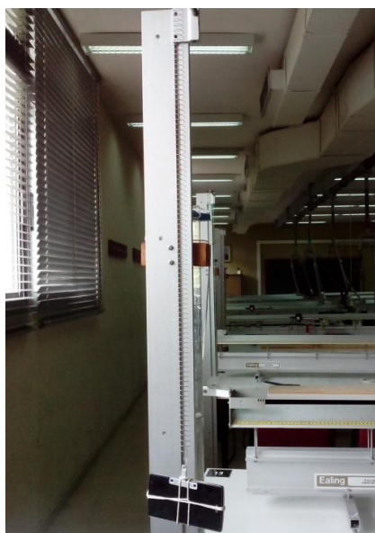
Σχήμα 3.7: Πειραματική διάταξη για τη μελέτη της απλής αρμονικής ταλάντωσης μέσω μετρήσεων συχνοτήτων.
