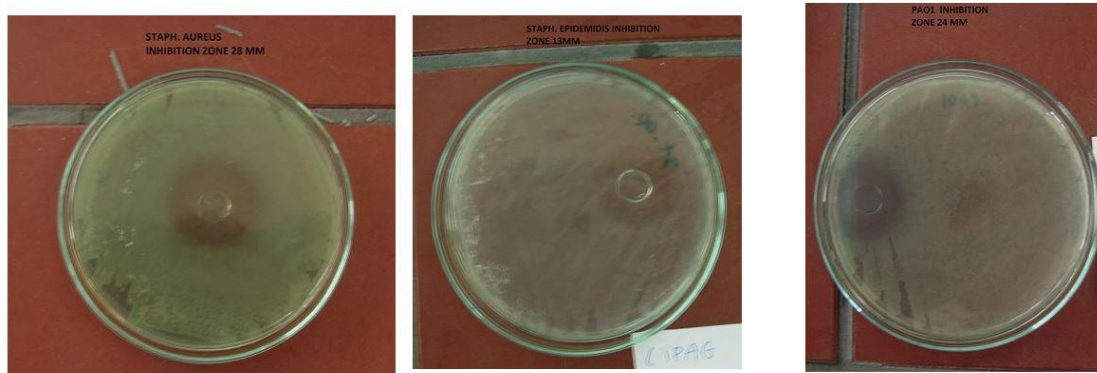
Εικόνα 7 Οι ζώνες αναστολής του υδροτζέλ PHEMA συγκέντρωσης 2,95 \mu M κατά σειρά από αριστερά προς τα δεξιά στα μικρόβια Staph. Aureus, Staph. Epidermidis, PA01 διαδοχικά.
