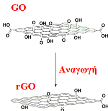
Εικόνα 3.5. Σχηματική αναπαράσταση ενός φύλλου οξειδίου του γραφενίου (GO) πριν και μετά την αναγωγή (rGO).
