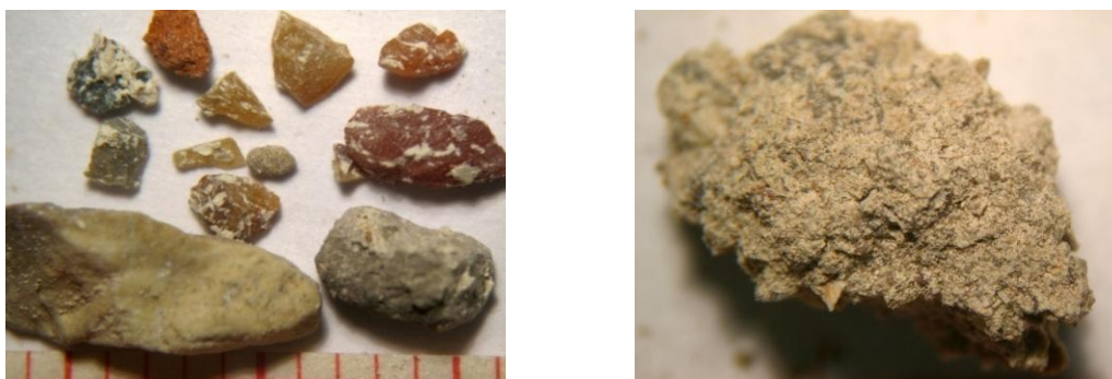
Εικόνα 4. Αριστερά: κόκκοι αδρανών, δείγμα E8, 12x (απόσταση μεταξύ διαδοχικών γραμμών στον δείκτη στην βάση της εικόνας: 1 mm). Δεξιά: δείγμα FN10, 12x.
