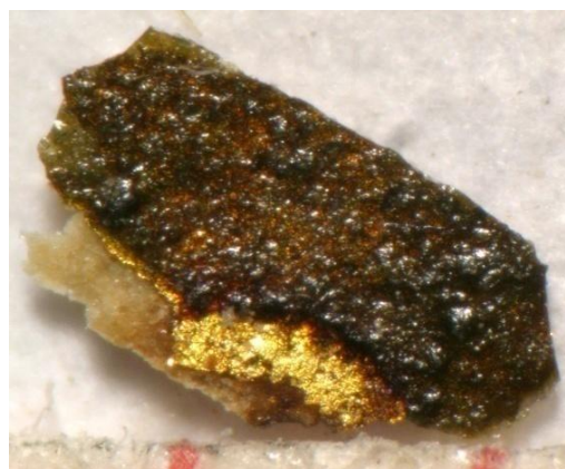
Εικόνα 90. Αριστερά: κόκκοι Cu/Cl (βέλη) διεσπαρμένοι εντός οργανικής μήτρας (λευκή κάθετος). Δείγμα από την εικόνα '50', BSE 3000x. Δεξιά: δείγμα από φύλλο αμπέλου εικόνας '50'. Διακρίνονται τα χαρακτηριστικά διαφάνειας του υποκάστανου χρωματικού στρώματος που κείται επί φύλλου χρυσού. Μέγιστη διάσταση δείγματος \approx 1.8\text{mm} , στερεοσκόπιο, 40x.
