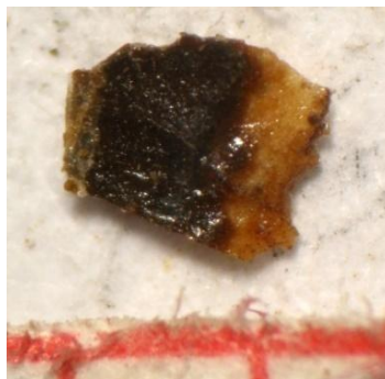
Εικόνα 147. Αριστερά: μικροδείγμα από φορητή εικόνα β' μισού 17 ου αιώνας. Στερεοσκόπιο, μεγέθυνση 40x. Η υποδιαίρεση της ερυθρής κλίμακας αντιστοιχεί σε 1 mm. Δεξιά: στιλπνή τομή μικροδείγματος από εικόνα 17 ου αιώνας. ΟΜ, μεγέθυνση 100x.
