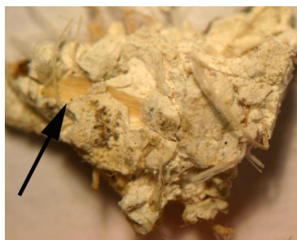
Εικόνα 2. Αριστερά: ημιδιαφανείς, επιμήκεις ίνες εντός επιφανειακού κονιάματος. Δείγμα E2, μεγέθυνση 32x. Δεξιά: δείγμα FL7, 20x. Με βέλος σημειώνεται τεμάχιο άχρουν.
