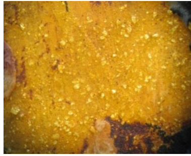
Εικόνα 186: χαρακτηριστική εμφάνιση κόκκων κίτρινης σανδαράχης υπό το στερεοσκόπιο. Λεπτομέρεια από την επιφάνεια κίτρινου χρωματικού στρώματος στην εικόνα '54' (αρχών 19 ου αιώνας).
