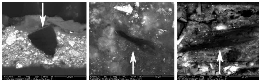
Εικόνα 65. Αριστερά: οιονεί γωνιώδης κόκκος μαύρης ανθρακούχου χρωστικής (BSE, 5000x). Μέσο: διακλαδισμένος κόκκος, (BSE, 10000x). Δεξιά: κόκκος που διατηρεί χαρακτηριστικά κυτταρικής δομής ξύλου, (BSE, 5000x).
