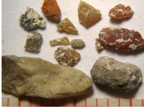
Εικόνα 4. Αριστερά: κόκκοι αδρανών, δείγμα E8, 12x (απόσταση μεταξύ διαδοχικών γραμμών στον δείκτη στην βάση της εικόνας: 1 mm). Δεξιά: δείγμα FN10, 12x.
