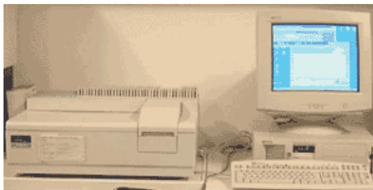
Σχήμα 17: Φασματοφωτόμετρο UV-Vis. Μοντέλο Lambda 40 Perkin Elmer.
