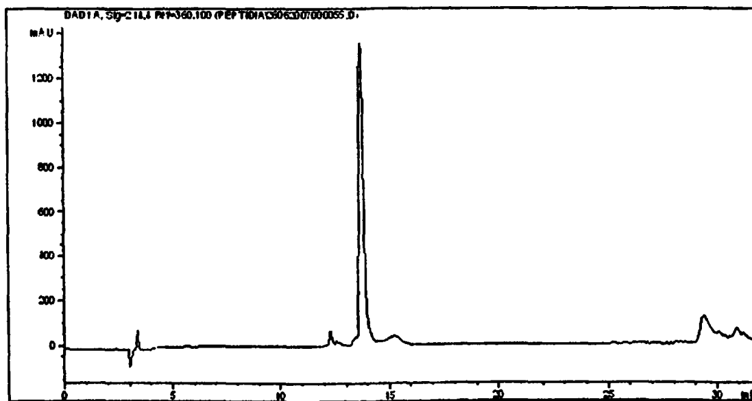
Σχήμα 13. Χρωματογράφημα Αναλυτικής RP-HPLC του καθαρού πεπτιδίου T7. Βαθμιδωτό σύστημα έκλουσης 10% έως 60% CH 3 CN/0.1%TFA σε H 2 O/0.1%TFA με ταχύτητα ροής 1ml/min για 30 min, ανίχνευση στα 214nm.
