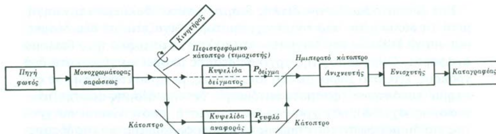
Σχήμα 7.9. Σχηματικό διάγραμμα φασματοφωτομέτρου διπλής δέσμης-μηδενισμού
