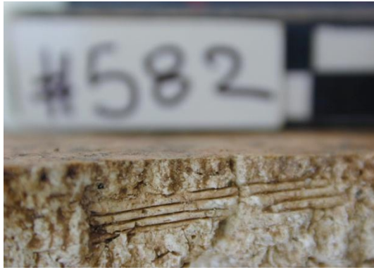
Εικ. 36β. Ακρωτήρι, Θήρα. Κτήριο Β, Δωμ. 6: τομή σπαράγματος. Διακρίνονται τα αποτυπώματα από άχυρο στο εσωτερικό του κονιάματος.
