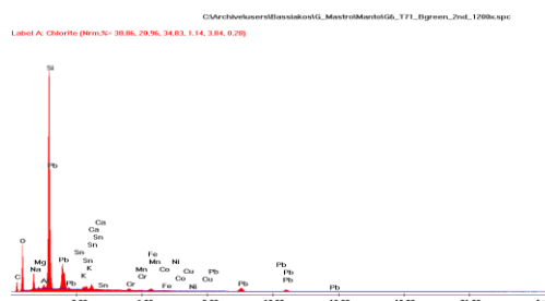
Εικόνα 42: Στρώμα 1- πράσινο υάλωμα, Στρώμα 2-επίχρισμα, Στρώμα 3:πηλός Εικόνα 43:Φάσμα πράσινης χρωστικής υαλώματος
