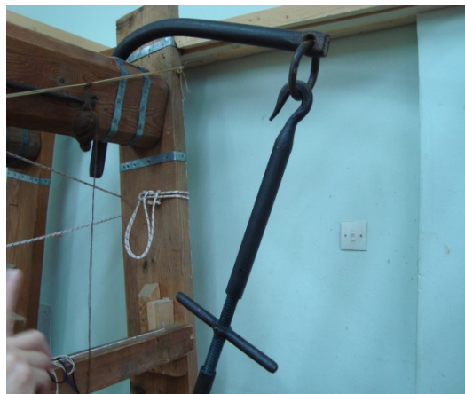
Εικ. 118: Το γυριστό σίδερο και η μηχανή που καταλήγει στο στεφάνι και σφίγγει το στημόνι.
