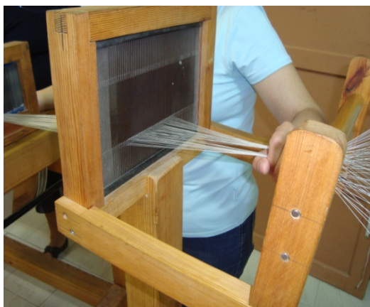
Εικ. 11: Στο πρώτο μεγάλο χτένι γίνεται η σταύρωση των κλωστών που βγαίνουν απ' το κλουβί.
