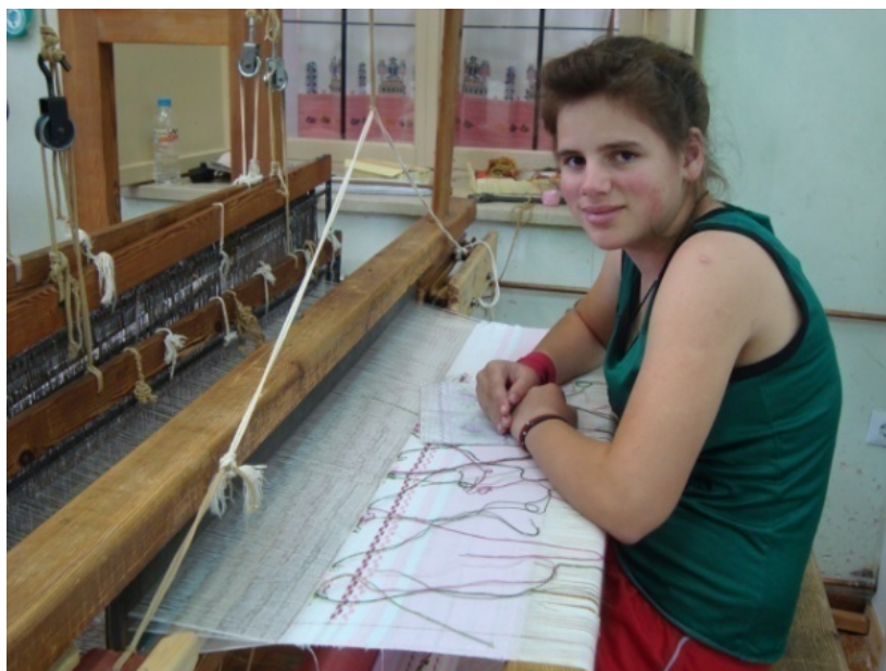
Εικ. 40: Πάτημα της δεξιάς πατήθρας για να περαστεί το σχέδιο στο ύφασμα.
