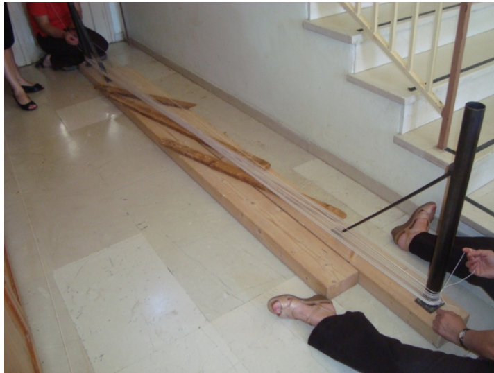
Εικ. 103: Διάστρα χαλιού που αποτελείται από δυο σίδερα καρφωμένα σε σανίδια σε τόση απόσταση μεταξύ τους όση πρέπει είναι η διάσταση του χαλιού.
