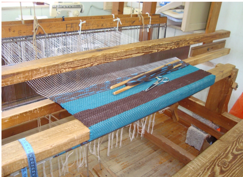
Εικ. 22: Αργαλειός για κατασκευή χοντρών υφασμάτων (κουρελούδες, μπαχτά) με πιο αραιό χτένι, δυο μιτάρια σε αντίθεση με τον παραπάνω που έχει τέσσερα. Επίσης η σαΐτα είναι διαφορετική ώστε να δέχεται τα κουρελονήματα.
