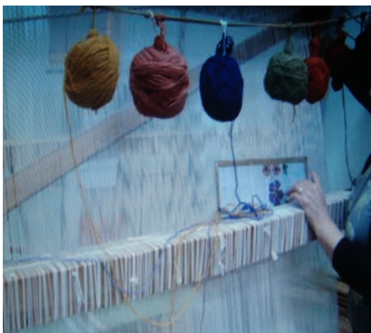
Εικ. 133: Ανέβασμα του ξύλου της σταύρωσης ώστε να έρθουν οι πίσω κλωστές μπροστά.
