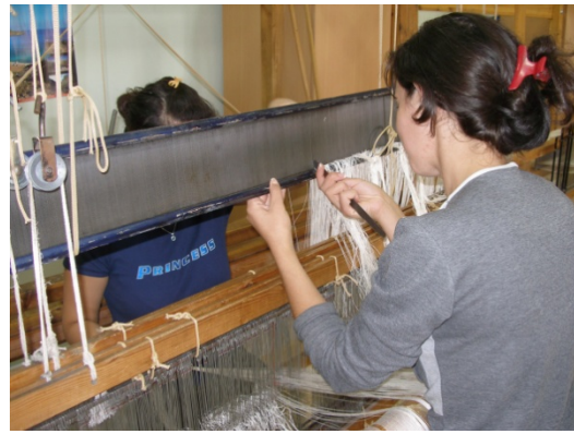
Εικ. 36: Το πέρασμα των κλωστών στο χτένι, ή περαμάτιση .
