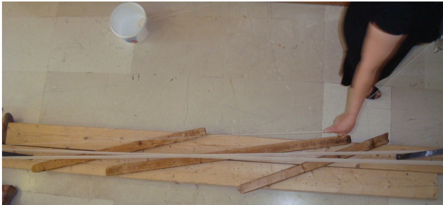
Εικ. 104: Οι κλωστές περνιούνται στα σίδερα σταυρωτά ώστε να τακτοποιούνται.
