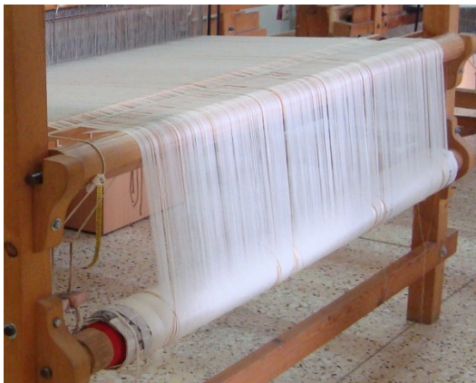
Εικ. 25: Το πίσω αντί ή πιασάντι όπου τυλίγεται το στημόνι και το πανάντι το οποίο ευθυγραμμίζει τις κλωστές με τα μιτάρια και το χτένι.
