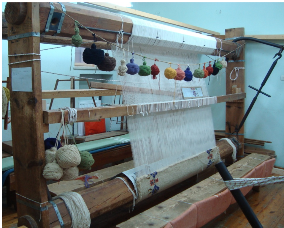
Εικ. 115: Ο αργαλειός ταπητουργίας όπου διακρίνονται τα δυο οριζόντια δοκάρια ή κορμοί τα οποία φέρουν κυλινδρικές υποδοχές για να εφαρμόζουν τα δυο πλαγιοσάνιδα, το μιταρόξυλο και το ξύλο της σταύρωσης.
