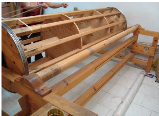
Εικ. 9: Διάστρα : κυλινδρική κατασκευή όπου μαζεύεται το στημόνι.
