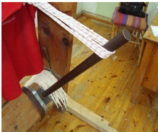
Εικ. 117: Ο μοχλός που κρατάει το υφασμένο χαλί στη θέση που εξυπηρετεί την υφάντρια.
