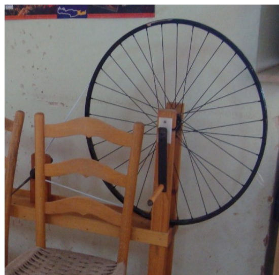
Εικ. 34: Η ανέμη ή μασουρίστρα που μαζεύει τη κλωστή στο μασούρι.
