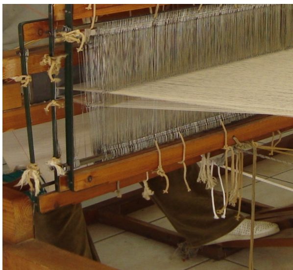
Εικ. 40: Πάτημα της δεξιάς πατήθρας για να περαστεί το σχέδιο στο ύφασμα.
