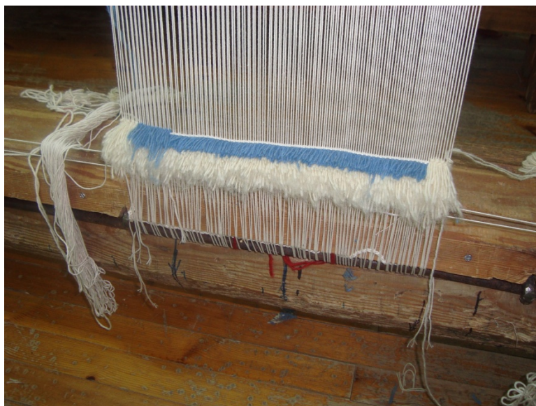
Εικ. 126: Κατασκευή κιλμιού δηλαδή σκέτου υφαδιού, μετά το οποίο ξεκινούν οι κόμπτοι. Εδώ έχουν ξεκινήσει και οι κόμπτοι.
