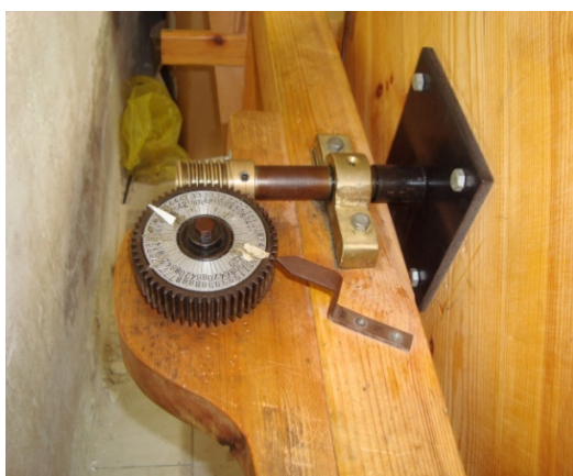
Εικ. 13: Το ρολόι ρυθμίζει τα μέτρα του στημονιού.
