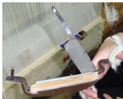
Εικ. 122: Το ψαλίδι που τελειοποιεί τους κόμπους και αυξομειώνει το πάχος του χαλιού.
