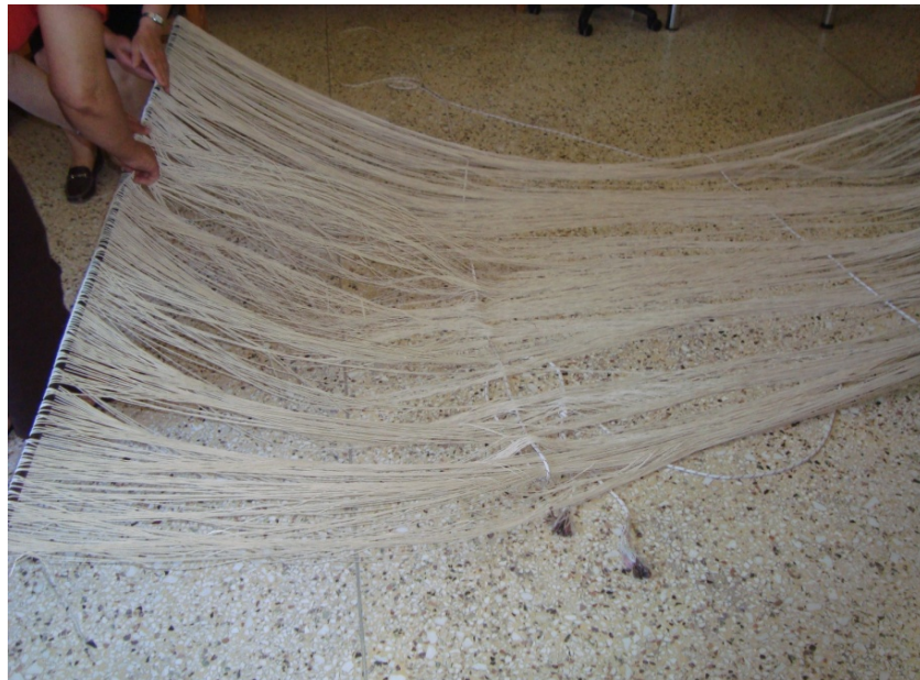
Εικ. 108: Περνιούνται οι σιδερόβερρες ώστε να μεταφερθεί στον αργαλειό.
