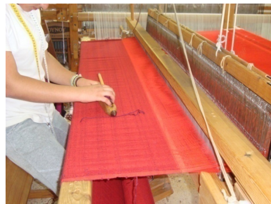
Εικ. 38: Πέρασμα της κλωστής στη σαΐτα και αρχή της ύφανσης.
