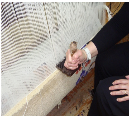
Εικ. 132: Χτύπημα του υφαδιού με το χτένι.
