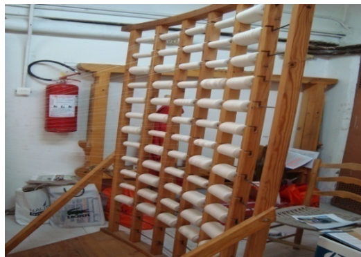
Εικ. 10: Κλουβί : κατασκευή όπου τοποθετούνται οι μπομπίνες που θα δώσουν τις κλωστές για το στημόνι.
