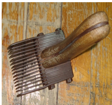
Εικ. 120: Το χτένι με το οποίο χτυπιέται το υφάδι για να τακτοποιηθούν οι κόμποι.
