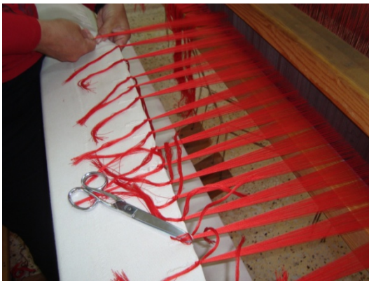
Εικ. 37: Το δέσιμο του στημονιού στο καρ-βόπανο για να αρχίσει το ύφασμα.
