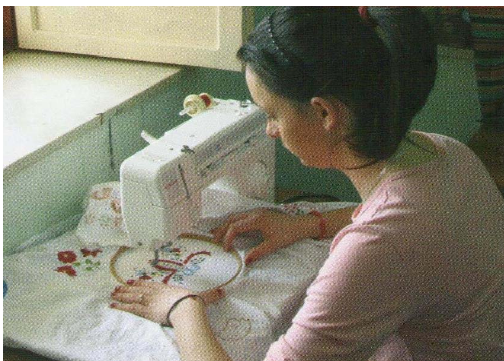
Εικ. 86: Μαθήτρια ασκείται στην κεντητική μηχανής. Διακρίνεται η μηχανή και το τελάρo στο οποίο τεντώνει το ύφασμα και κεντιέται.
