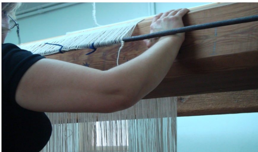
Εικ. 111: Τοποθέτηση στημονιού στον πάνω κορμό του αργαλειού.
