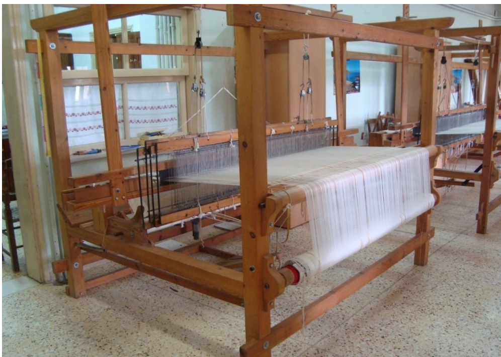
Εικ. 21: Αργαλειός καθιστός ή αρμένικος όπου διακρίνεται ο σκελετός ή σκαρί με τα τέσσερα κάθετα δοκάρια ή στύλοι, που συνδέονται με δυο οριζόντια δοκάρια και αυτά με δυο περαστά σανίδια.
