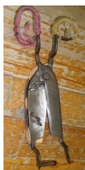
Εικ. 122: Το ψαλίδι που τελειοποιεί τους κόμπους και αυξομειώνει το πάχος του χαλιού.
