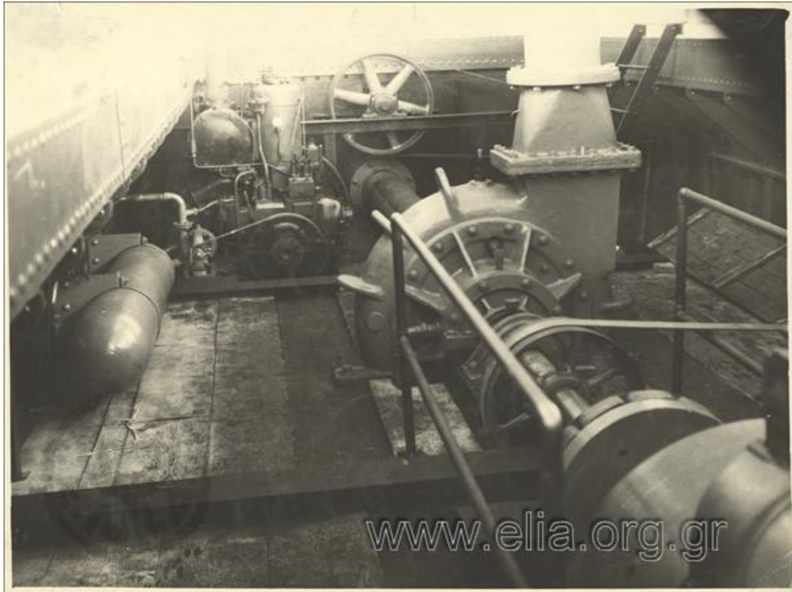
Φωτογραφία 20. Αποξηραντικά έργα στο έλος Λεσίνι: η αντλία αναρροφήσεως και εκπομπής βυθοκορημάτων στο κατάστρωμα της βυθοκόρου "Επαμεινώνδας" (σχεδιασμένη από τον Μιχαήλ Συκώκη). Πηγή: Αρχείο ΕΛΙΑ 1934-1940.
