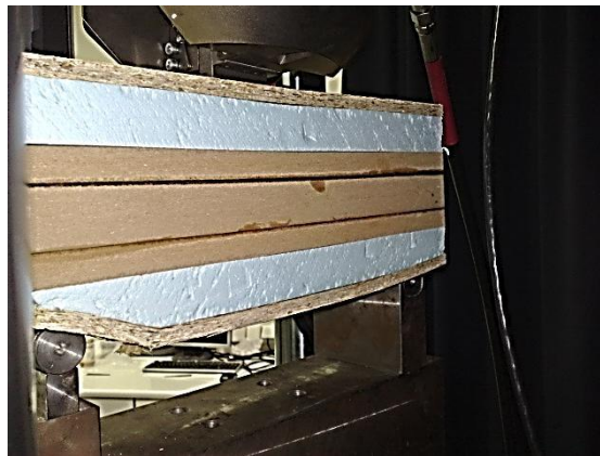
Εικόνα 23. Δοκίμιο υπό καταπόνηση σε κάμψη 3 σημείων
