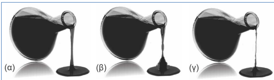
Σχήμα 20. (α) Σωστή και (β), (γ) λάθος ροή μελανιού.
