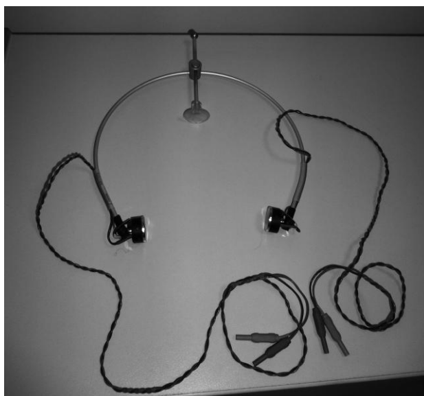
Εικόνα 2.6.1. Το σύστημα ηλεκτροδίων τύπου DTL που χρησιμοποιήθηκε για την καταγραφή full field ERG, pattern ERG και multifocal ERG.
