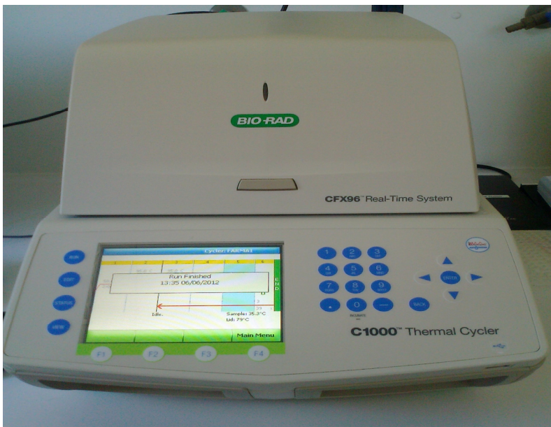
Εικόνα 17. Ο θερμοκυκλοποιητής C1000 που χρησιμοποιήθηκε στην πειραματική διαδικασία.
