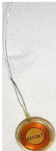
Εικ. 2. εσωτερικός δέκτης-διεγέρτης του μονοκάναλου εμφυτεύματος 3M (House).
