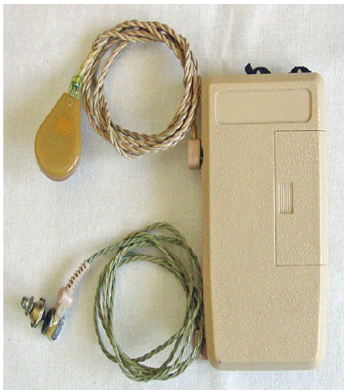
Εικ. 1. εξωτερικός επεξεργαστής ομιλίας του μονοκάναλου εμφυτεύματος 3M (House).
