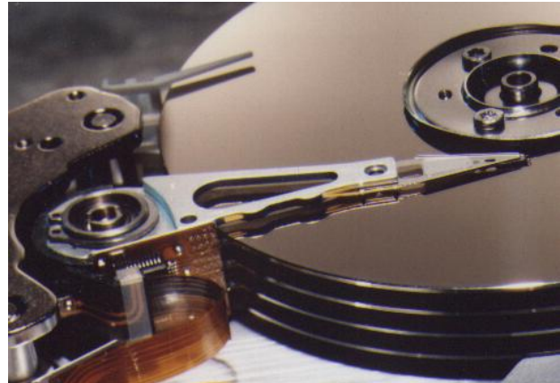
Εικόνα 6: Η κεφαλή ανάγνωσης/εγγραφής
