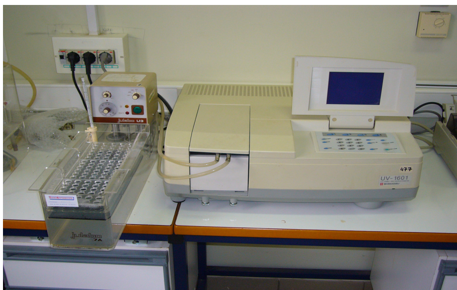
[Εικόνα 2] Η μετρητική διάταξη των πειραμάτων (φωτόμετρο Shimadzu συνδεδεμένο με υδατόλουτρο Julabo με ρυθμιζόμενο θερμοστάτη).
