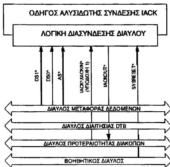
Σχήμα ΒΠ. 9: Διάγραμμα βαθμίδας οδηγού αλυσιδωτής σύνδεσης ΙΑΚΚ
