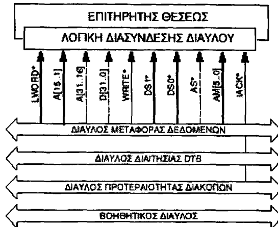
Σχήμα ΒΠ. 5: Διάγραμμα βαθμίδας επιτηρητή θέσεως
