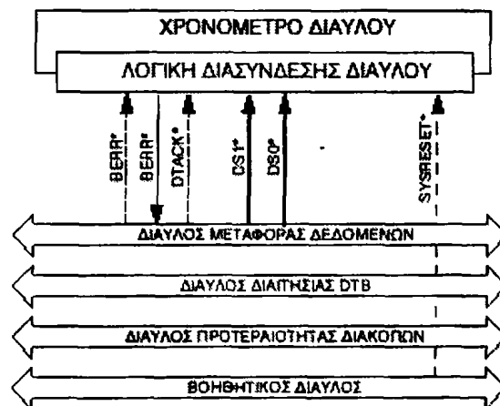
Σχήμα ΒΠ. 6: Διάγραμμα βαθμίδας χρονομέτρου διαύλου
