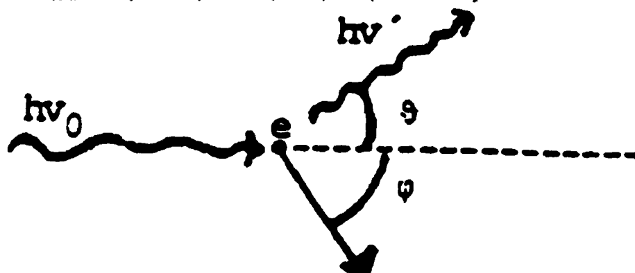
Σχήμα 14 : Σχηματική αναπαράσταση του φαινομένου Compton
