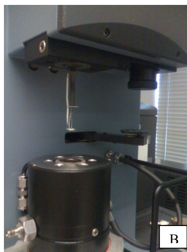
Σχήμα 4.28: (A) Οργανολογία TGA που χρησιμοποιήθηκε της εταιρίας TA Instruments μοντέλο TGA Q50. (B) Δειγματοφορέας Pt κατά την ώρα της βαθμονόμησης του οργάνου.
