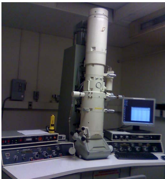
Σχήμα 4.50: Απεικόνιση Ηλεκτρονικού Μικροσκοπίου Διέλευσης (TEM) τύπου JEOL 200CX.
