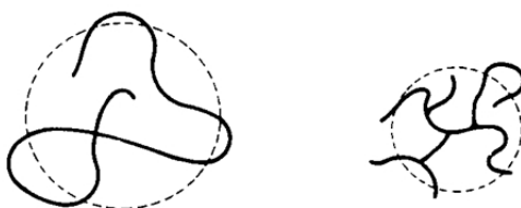
Σχήμα 2.41: Μέγεθος μορίων ενός γραμμικού και ενός διακλαδισμένου πολυμερούς ίδιου μοριακού βάρους σε διάλυμα 109 .
