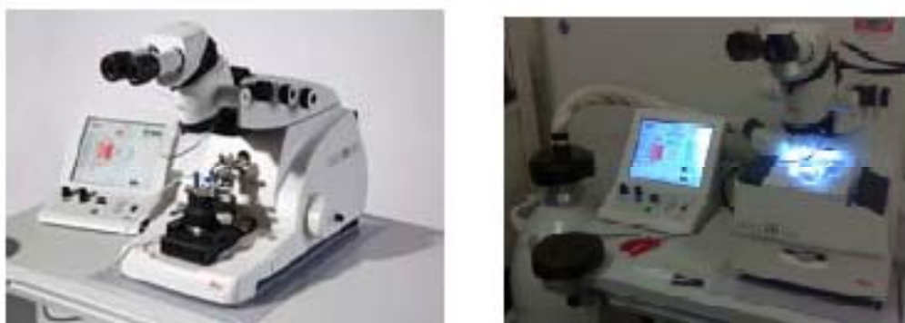
Σχήμα 4.45: Διαμόρφωση μικροτόμου Leica EM UC6 για χρήση σε θερμοκρασία περιβάλλοντος (αριστερά) και για χρήση σε χαμηλές θερμοκρασίες (δεξιά) όπου διακρίνεται το δοχείο υγρού αζώτου συνδεδεμένο με την κεντρική μονάδα.
