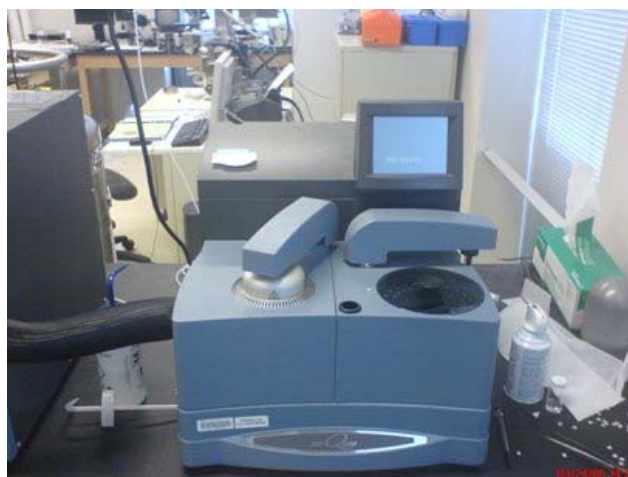
Σχήμα 4.27: Οργανολογία DSC που χρησιμοποιήθηκε της εταιρίας TA Instruments μοντέλο DSC Q1000. Με δυνατότητα μετρήσεων χαμηλών θερμοκρασιών ( -100^{\circ}\text{C} ) μέσω κεντρικής παροχής αερίου αζώτου σε χαμηλή πίεση.
