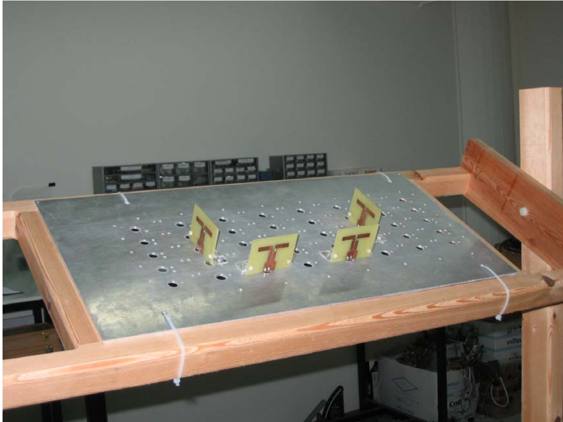
Σχήμα 5.22. Κεραιοσυστοιχία τεσσάρων τυπωμένων διπόλων σε διάταξη 2 \times 2 στον ανακλαστήρα της ξύλινης βάσης υποστήριξης ως στοιχειοκεραία εκπομπής συστήματος MIMO
