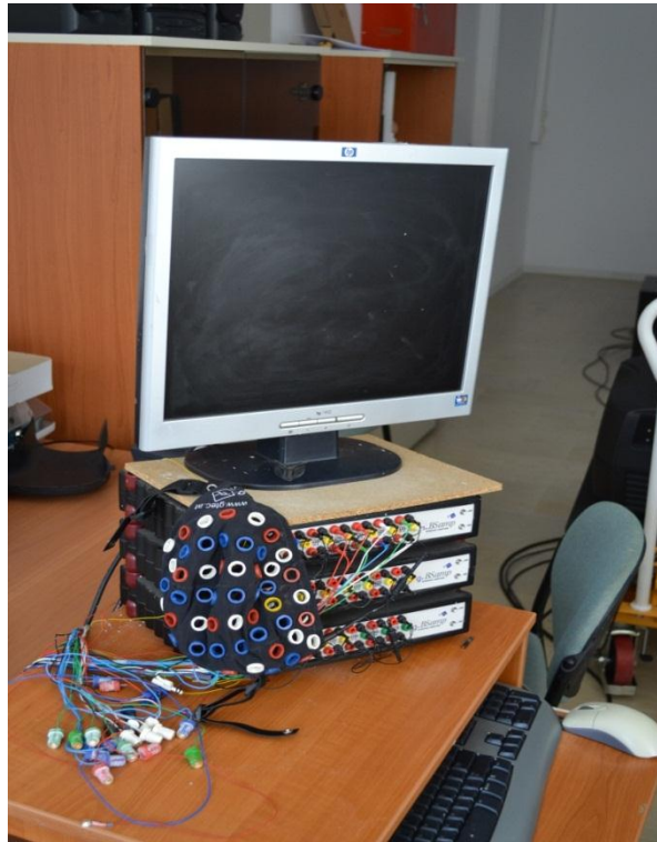
Σχήμα 4.5. Το σύστημα ψηφιακής ηλεκτροεγκεφαλογραφίας του Εργαστηρίου Εφαρμογών Εικονικής Πραγματικότητας στην Εκπαίδευση, του Παιδαγωγικού Τμήματος Δημοτικής Εκπαίδευσης, στο Πανεπιστήμιο Ιωαννίνων.
