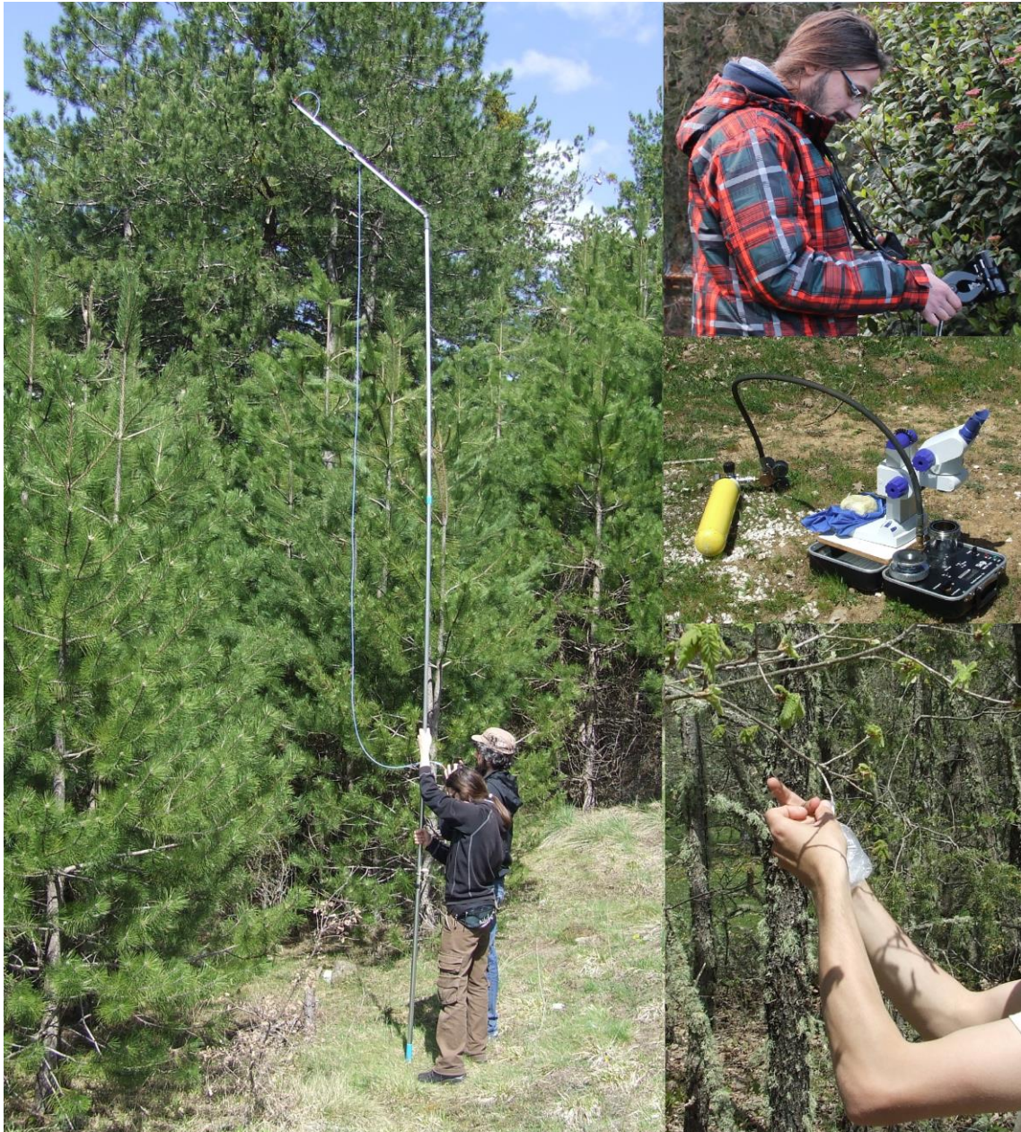
Εικόνα 15. Εργασίες στο πεδίο. Στη μεγάλη φωτογραφία παρουσιάζεται η διαδικασία μέτρησης ανακλαστικότητας θόλου, σε συνεργασία με τον Δρ. Σταύρο Σταγάκη. Πάνω δεξιά παρουσιάζεται η μέτρηση ανακλαστικότητας φύλλου με το μανταλάκι φύλλου. Ακριβώς από κάτω φαίνεται ο θάλαμος πίεσης SKPM-1400 έτοιμος για χρήση, ενώ κάτω δεξιά παρουσιάζεται η προετοιμασία ενός δείγματος για μέτρηση δυναμικού στο θάλαμο.
