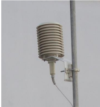
Εικόνα 44: Αισθητήρες θερμοκρασίας και σχετικής υγρασίας αέρα σε προστατευτικό κλωβό
