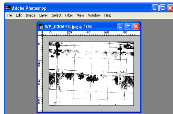
Εικόνα 42: Image > Mode > Grayscale και Image > Adjust > Brightness/Contrast: Brightness=+50, Contrast=+100
