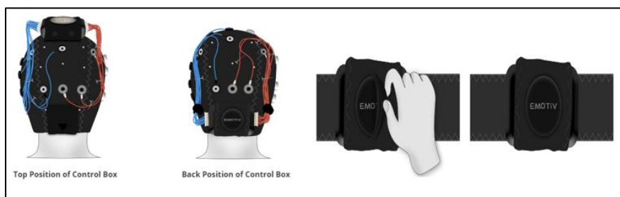
Εικόνα 4. 7 Τρόποι τοποθέτησης της συσκευής ελέγχου
